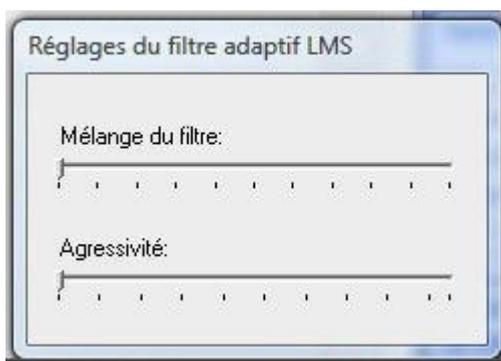
Ce filtre prend en compte les corrections passées en RA et ajuste le filtre FIR (Finite Impulse Response) de manière optimale pour mieux distinguer le bruit d'erreurs réelles, sans que cela ne cause de dérive dans le temps.
